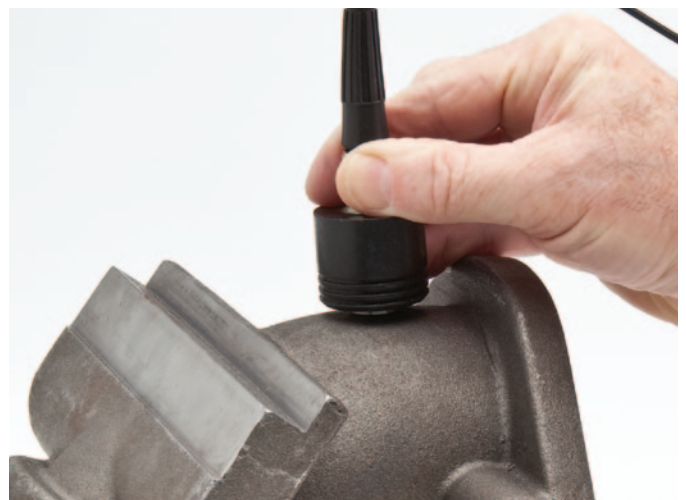
高穿透软件选项可以对很多铸造金属部件及声波衰减性强的材料进行测量。
