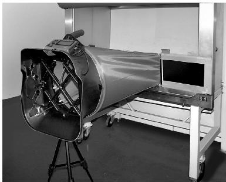
图 21 直接流入测试编织罩
