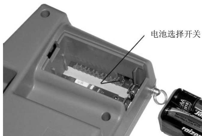
图 6： 电池型式选择开关位置
