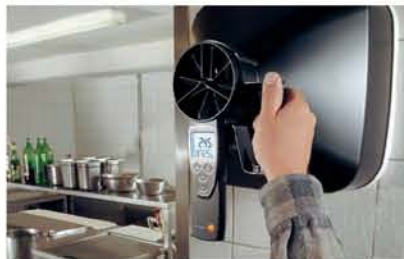
testovent 417风量罩， 支持各种出风口规格。
