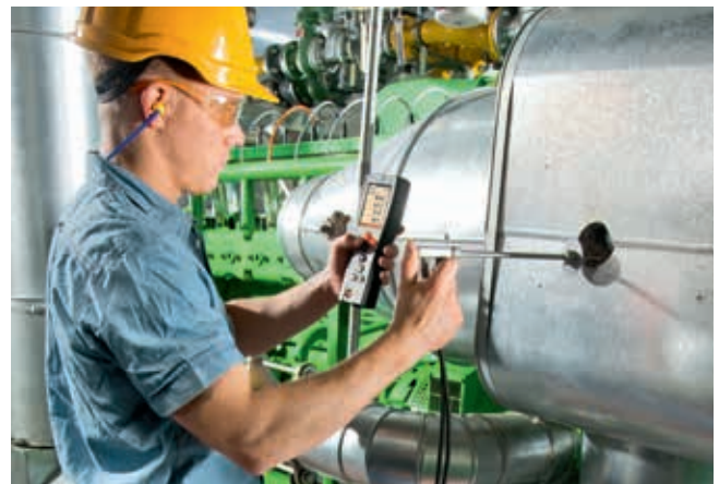
图 2：testo 350 对发动机的烟气组分进行测量
