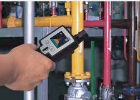
使用内置激光指示器远距离检测泄露
