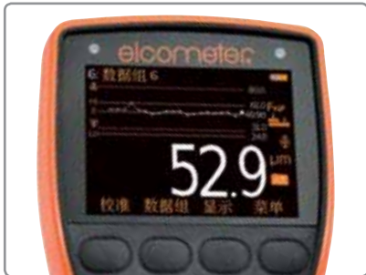
屏幕趋势图显示最后20个测量值
