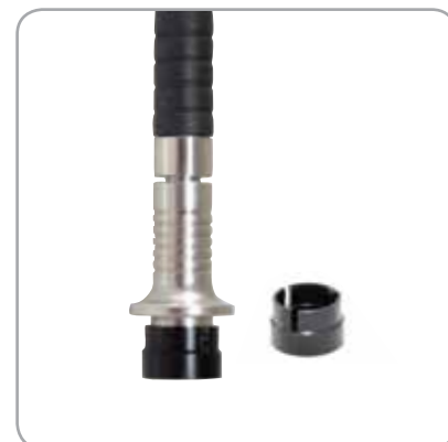
超声/扫描探头具有备用保护盖，增加了耐用性
