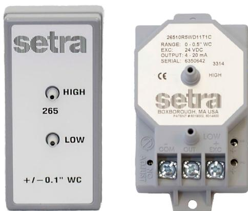
Setra 的 Model 265 是高性能, 适当价格的一款产品, 满足典型的暖通空调应用要求。Model 265 是一款微差压传感器, 使用了一个正负压相互隔离的电容式传感元件, 只需要很小的放大就能输出标准的电信号, 提供高质量的精度和长期稳定性。标准精度是  $\pm 1\%FS$ , 并提供了  $\pm 0.25\%FS$  和  $\pm 0.4\%FS$  的精度选项, 压差范围从 0.25"W.C. 到 100"W.C.。Model 265 具有较小的体积、交流电源选项和可选的电气导管盖, 可以在任何应用中进行方便、安全的安装。
