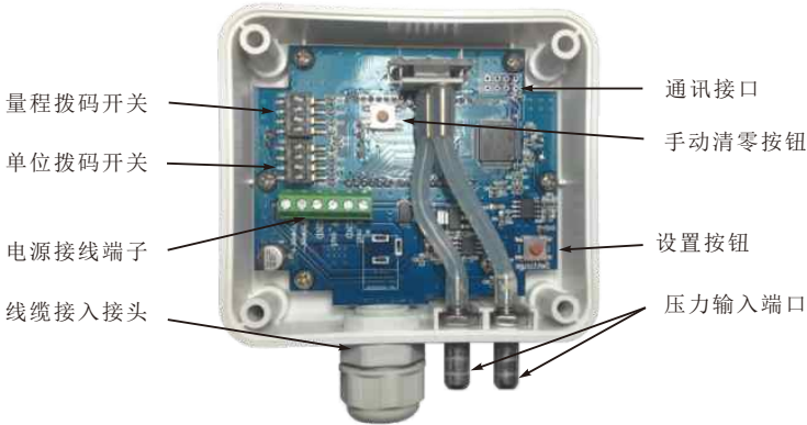
图1 LFM11X-XAX内部电路
