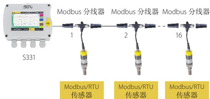
Modbus/RTU 总线可将多个传感器以菊花链方式接入同一条总线。
