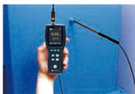
管道内风速、风量测试
