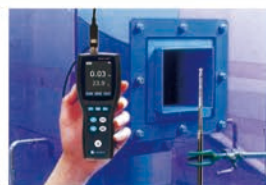
管道出风口测试
