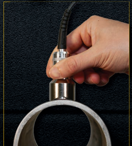
PosiTector SPG OS 粗糙度探头测量外圆面粗糙度
